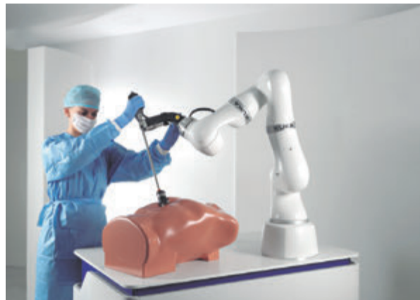
クカの超音波検査での協働ロボットの活用事例 Example of Ultrasound Exam Using KUKA's Collaborative Robot
