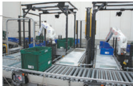
MUJINのロボットピッキングシステム MUJIN's robot picking system
