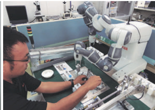
ABBが組み立て工程に導入した協働ロボット ABB's Collaborative Robot at the Assembly Stage
