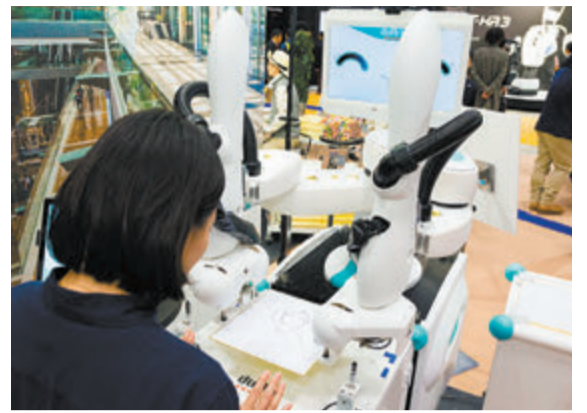
川崎重工業の双腕スカラロボ「duAro」 Kawasaki Heavy Industries' dual-arm robot “duAro”
